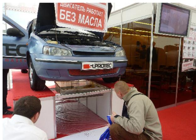
**Рис. 15.** У двигателя автомобиля «Лада», предварительно обработанного геомодификатором трения (ГМТ) производства ООО «НПТК «Супротек», снят поддон картера. Двигатель работает без моторного масла на холостых оборотах в течение всего дня. Выставка «Интеравто-2010», Москва, 2010 г.
