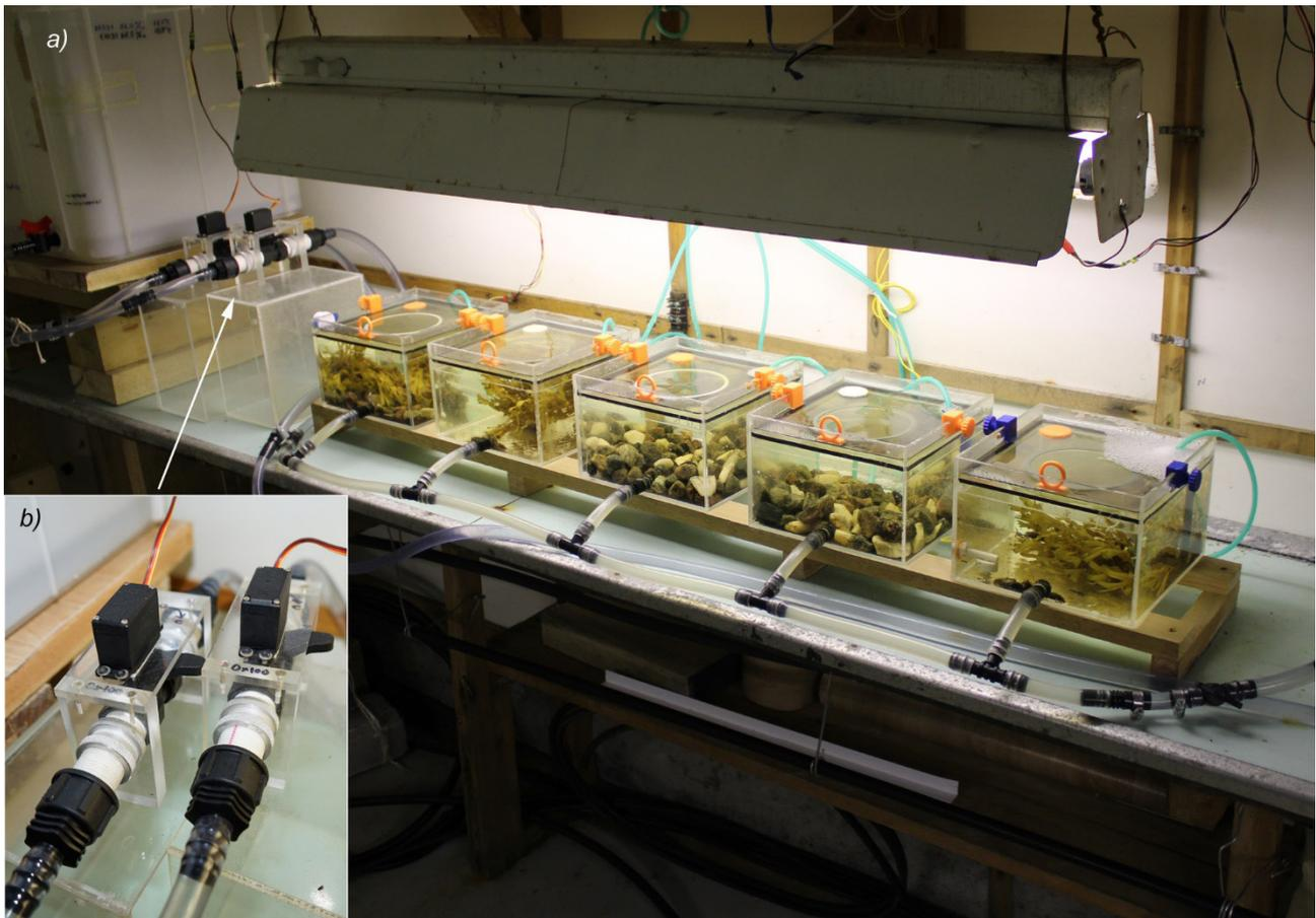
**Рис. 2.** Группа аквариумов в ходе эксперимента (a) и сконструированные нами клапаны (b)
