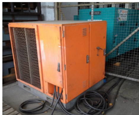
Рис. 10. Обработка дизель-генератора Denyo (фото слева). Уровень нагрузки определялся разными режимами мощности промышленного кондиционера (фото посередине). На фото справа — процесс измерения параметров работы дизель-генератора при разных режимах нагрузки. Сингапур, 2012. Для обработки использовались триботехнические составы производства ООО «С-Визард», Санкт-Петербург
