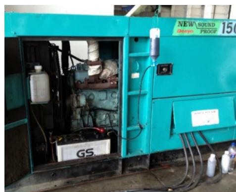
Рис. 10. Обработка дизель-генератора Denyo (фото слева). Уровень нагрузки определялся разными режимами мощности промышленного кондиционера (фото посередине). На фото справа — процесс измерения параметров работы дизель-генератора при разных режимах нагрузки. Сингапур, 2012. Для обработки использовались триботехнические составы производства ООО «С-Визард», Санкт-Петербург
