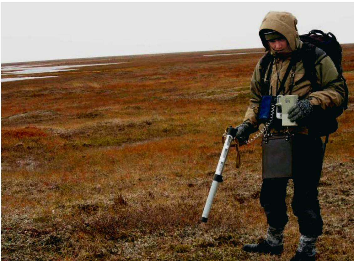
**Рис 8.** Выполнение гамма-поисковых работ с использованием ДКС-96 9 (фото автора)
