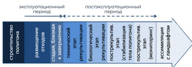
**Рис. 1.** Схема жизненного цикла полигона [1]
