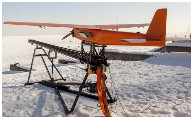
**Рис. 2.** БПЛА «Археон» на стартовой катапульте
