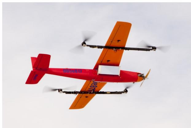
**Рис. 4.** При стартовом подъеме БПЛА маршевый двигатель внутреннего сгорания не работает
