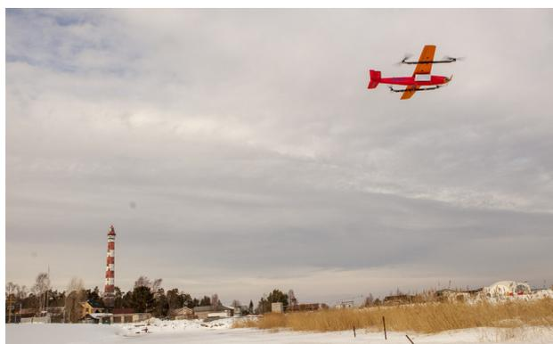
**Рис. 3.** БПЛА «Археон-ВВП» осуществляет стартовый подъем на электромоторах
