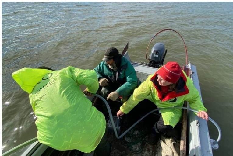
**Рис. 3.** Отбор проб воды с помощью пробоотборника «HydroPuMP-5» ПластикЛаб РГГМУ (использование защитных плащей яркого цвета для контроля загрязнения)
