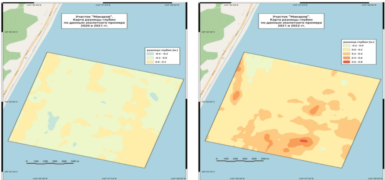
**Рис. 6.** Карты изменения донного рельефа, связанные с накоплением и размывом донных осадков. Результаты мониторинга 2020–2022 гг. [9]
