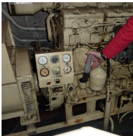
Рис. 11. Процесс обработки ГМТ-составом дизель-генератора (фото слева) сухогрузного судна общего назначения «Омский-140» (фото справа). Санкт-Петербург, 2013 г. Использовались составы производства ООО «С-Визард»
