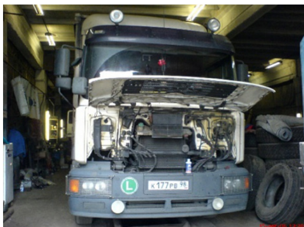
Рис. 6. Фото слева — обработка АРТ-составами (вводятся через щуповое отверстие) дизельного ДВС одного из грузовиков компании «Транс-Арт», Санкт-Петербург, 2008. Справа представлен Акт о результатах применения триботехнического состава марки «АРТ», из которого видно, что экономия топлива составила почти 11 % с заметным улучшением других параметров работы двигателя
