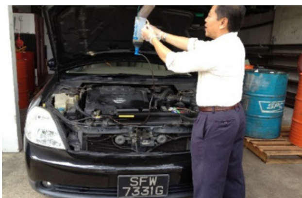
Рис. 3. Обработка двигателя легкового автомобиля (пробег 350 000 км) — фото слева и такси (пробег 720 000 км) — фото справа. Сингапур, 2012. Смесь находится в самодельной «капельнице» и через катетер подается в двигатель, работающий на холостом ходу
