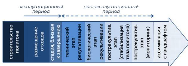
**Рис. 1.** Схема жизненного цикла полигона [1]
